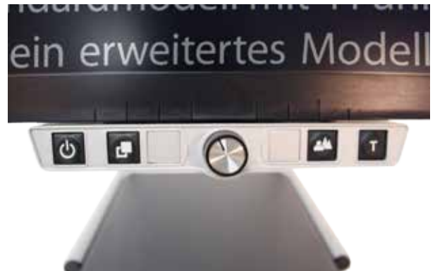
Erweitertes Bedienfeld mit 6 Funktionstasten und Drehregler.
